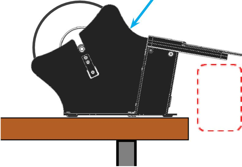
1. 結束機の先端がテーブルから突き出すように設置し、製品が入る空間を確保します
