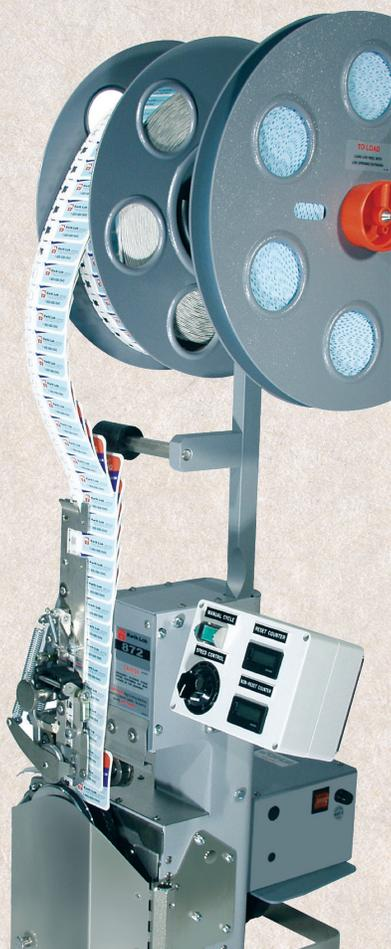
快洛客872XLSLM型全自动包装扎扣机可以使用带有标签的扎扣片为包装袋封口。单台机器封口速度最快每分钟可以达到105个袋子。适用于不同重量和大小的包装袋。在操作控制平台上可以监控封口速度，设定单个工作班次封口的包装袋数量。累计封口的包装袋总数。也可转为手动操作封口。
